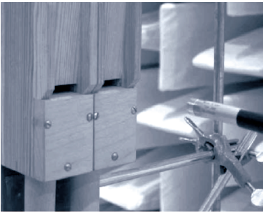
Abb. 1 Trotz unvermeidlicher Abweichungen voneinander können benachbarte Orgelpfeifen (links) exakt die gleiche Frequenz abstrahlen. Bei kleiner Frequenzverstimmung \Delta f der Pfeifen im ungekoppelten Zustand treten synchro-
