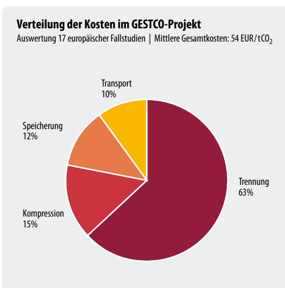
Abbildung 6-8: Verteilung der CCS-Kosten für Trennung, Kompression, Transport und Speicherung von CO 2 (GESTCO-Projekt)
