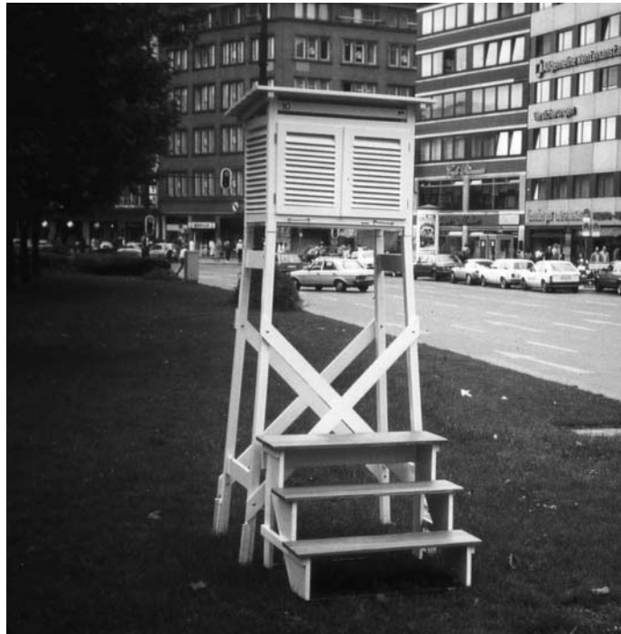
Abb. II.5: Meßstelle im Zentrum von München innerhalb des temporären Meßnetzes im Bodenniveau im Rahmen des Forschungsvorhabens STADTKLIMA BAYERN (aus BRÜNDL et al., 1987)
