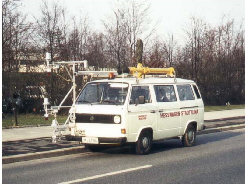
Abb. II.10: Meßwagen für thermische Profilfahrten im Rahmen des Forschungsvorhabens STADTKLIMA BAYERN
