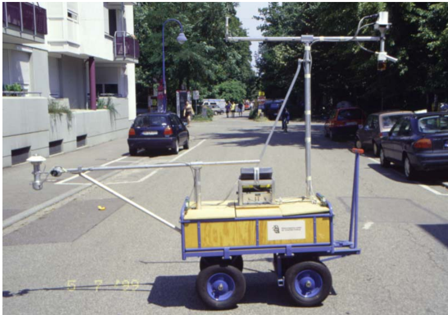
Abb. II.14: Mobiles human-biometeorologisches Meßsystem des Meteorologischen Institutes der Universität Freiburg für den Einsatz in urbanen Mikroklimaten (rechts oben: elektrisch ventiliertes Psychrometer zur Messung von Lufttemperatur und Bestimmung des Dampfdrucks, Mitte oben: Hitzdrahtanemometer zur Messung der Windgeschwindigkeit, links: um eine horizontale und vertikale Achse drehbar angeordnetes Pyranometer zur Messung der kurzwelligen Strahlungsflüsse und Pyrgeometer zur Messung der langwelligen Strahlungsflüsse)
