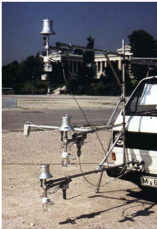
Abb. II.11: Anordnung von Meßwertgebern für thermische Profilfahrten vor der Front des Meßwagens aus dem Forschungsvorhaben STADTKLIMA BAYERN
