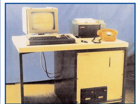
Rechts: Die Automatisch Fernmeldende Meteorologische Station zweiter Generation - AFMS-2, war im Betrieb vom 1. April 1985 bis März 2009 Foto von 1985
