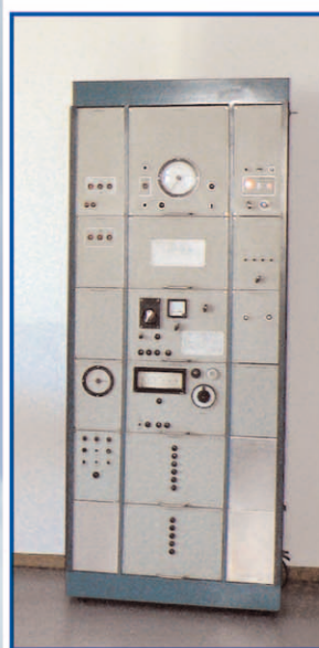
Oben: Die Automatisch Fernmeldende Meteorologische Station erster Generation AFMS-1. Sie verfügte u. a. über einen elektrischen Temperatur- und Taupunktfühler.
