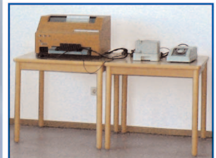
Einrichtung zur Datenübermittlung Links: Fernschreiber, Mitte: Lochstreifenleser und Rechts: das Anwahltelefon zur Übermittlung von Wetterdaten
