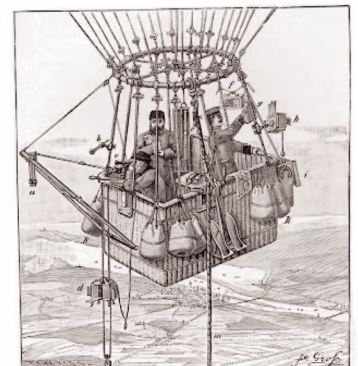
a) Nivirations-Probrometer, b) Sommerdreh-Überometer, c) Zählziffernrechner, d) Nivirations-Überometer, e) Quecksilber-Statometer, f) Barograph, g) Barometer, h) Nivirations-Überometer, i) Instrumententafel, k) Ballonhülle, l) Stativ mit Dreieck, m) Zählapparat.
